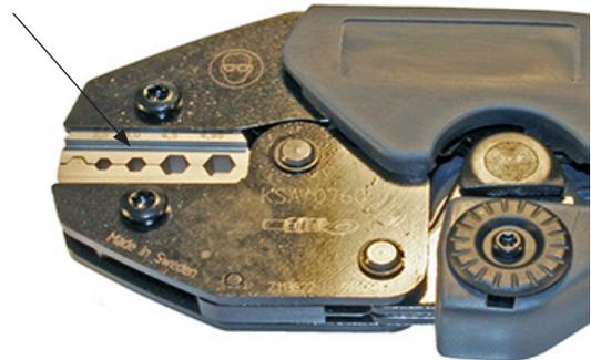
Bild 5 Crimpbereich 6-kant Crimpzange
